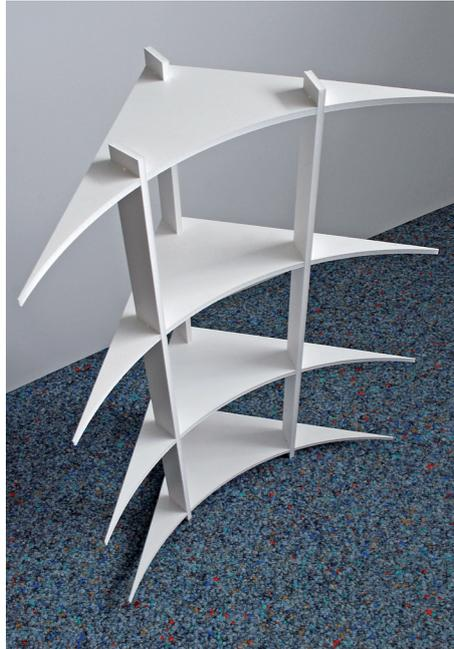
Eine professionelle und zudem extrem leichte Ausführung einer Stützkonstruktion zeigen diese Bilder. Die aus einer 10 mm starken Smart-X® Leichtstoffplatte gefrästen Teile sind als Stecksystem aufgenommen. So entsteht mit wenigen Handgriffen eine perfekte Stützkonstruktion (im Bild Radius 50 cm, Höhe 90 cm), welche mit Kartuschenkleber direkt in die Wandecke geklebt wird.
